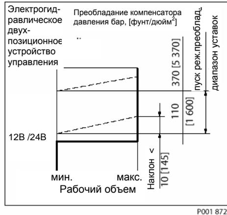
**Конфигурация компенсатора давления: T\*CA с гидравлическим отключением тормозного давления**
