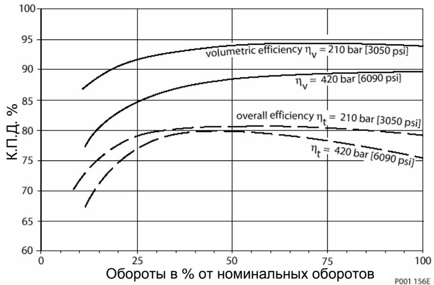
На данном графике показаны общие к.п.д. гидромоторов серий 51 и 51-1, работающих с рабочим объемом 30% от максимального рабочего объема, и при давлении в системе до 420 бар [6090 фунт/дюйм<sup>2</sup>], при вязкости жидкости 8,2 мм<sup>2</sup>/с [53 секунды по универсальному вискозиметру Сейболта]. Эти к.п.д. могут применяться для всех размеров.
