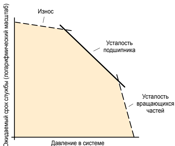
Срок службы гидравлического мотора в зависимости от давления в системе.
