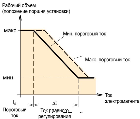
Диаграмма EP (зависимость рабочего объема от тока электромагнита).
