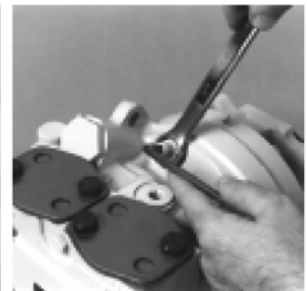
Затягивание фиксирующей гайки ограничителя
