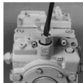
Снимите предохранительный клапан подпитки (настройка винтом) 90000264
