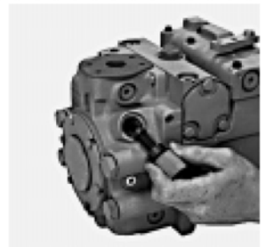
Предохранительный клапан подпитки (настройка шайбами)
