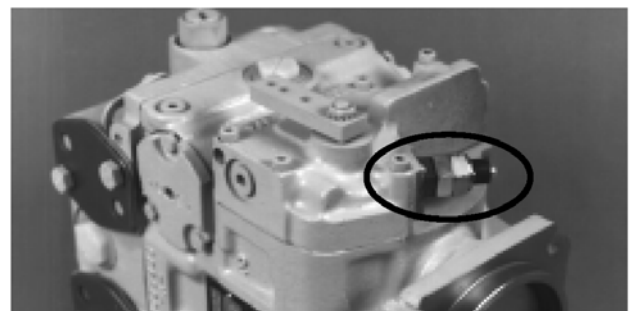
Насос PV с ручным управлением и переключателя NSS
