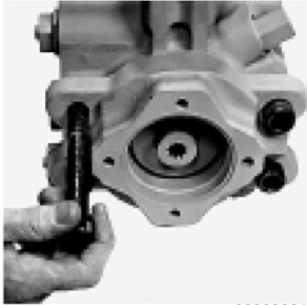
Снимите винты адаптера вспомогательного фланца
