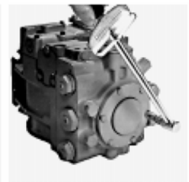
Затяжка болтов фиксатора
