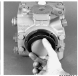
Установка крышки насоса подпитки
