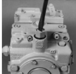
Регулируемый винтом предохранительный клапан подпитки (насос)
