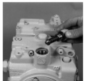
Предохранительный клапан подпитки (настройка винтом) 90000265
