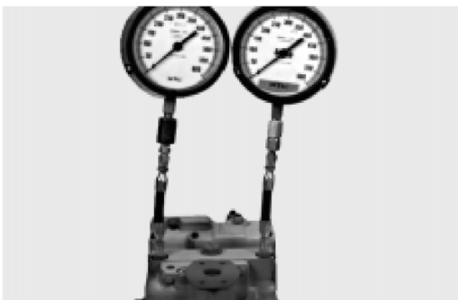
Установите манометры в измерительные порты цилиндра управления
