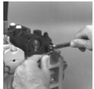
90000356 Затяните фиксирующую гайку вала регулировки нейтрали (Современные модели с HDC)
